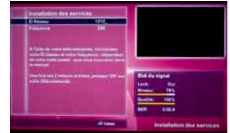
Après avoir introduit l'ID réseau en 4 chiffres et la fréquence en 6 chiffres, appuyer sur la touche **OK** de la télécommande pour lancer la recherche.
